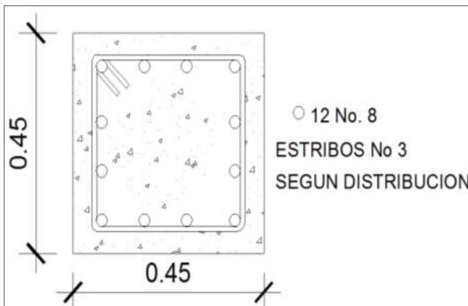
Figura 91. Detalle armado de columna
