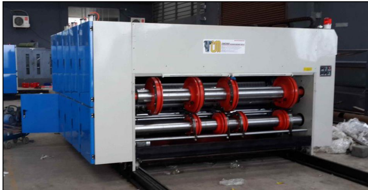
Figura 18. Máquina flexo para caja ranurada regular
