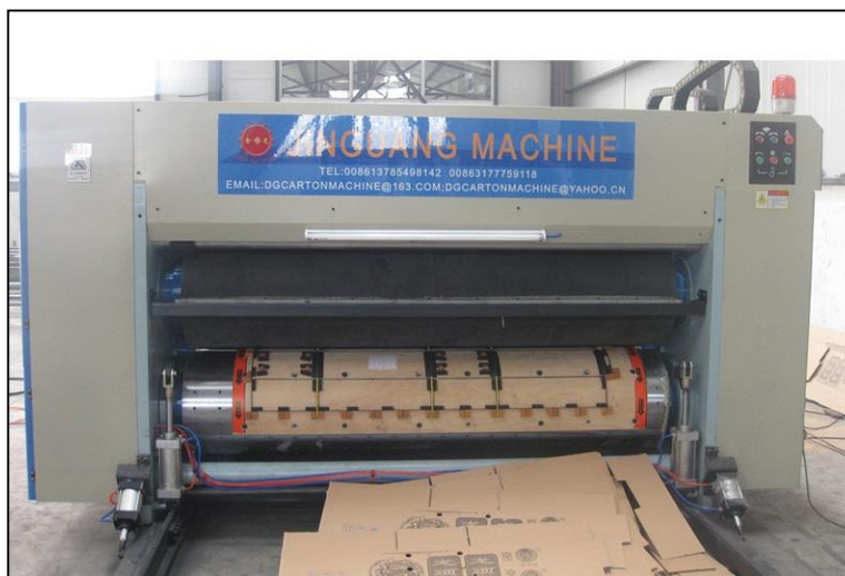
Figura 19. Máquina flexo para caja troquelada
