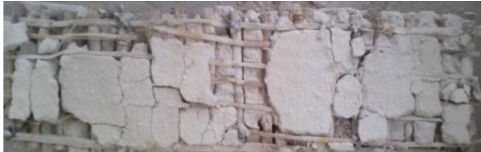
Figura 86. Detalle de fallas núcleo CeNca tipo “T”, muestra 4
