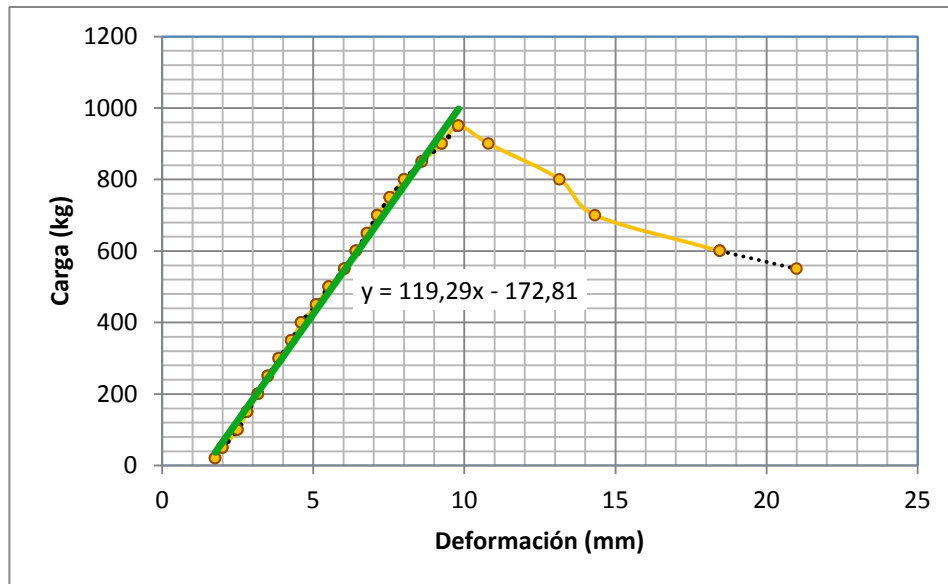
Gráfica carga versus deformación con línea de tendencia núcleo tipo "F" muestra 5
