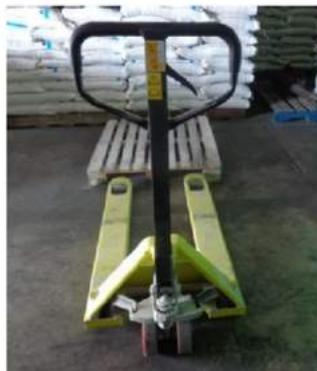
Fig. 21. Pallet (mula de carga) utilizada para cargar furgones.
