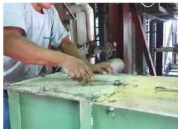
Fig. 8. Jefe de peletizado aprieta las tuercas mediante una llave.
