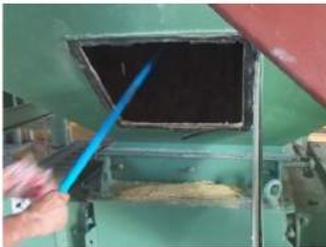
Fig. 4. Limpieza de la enfriadora de forma interna.
