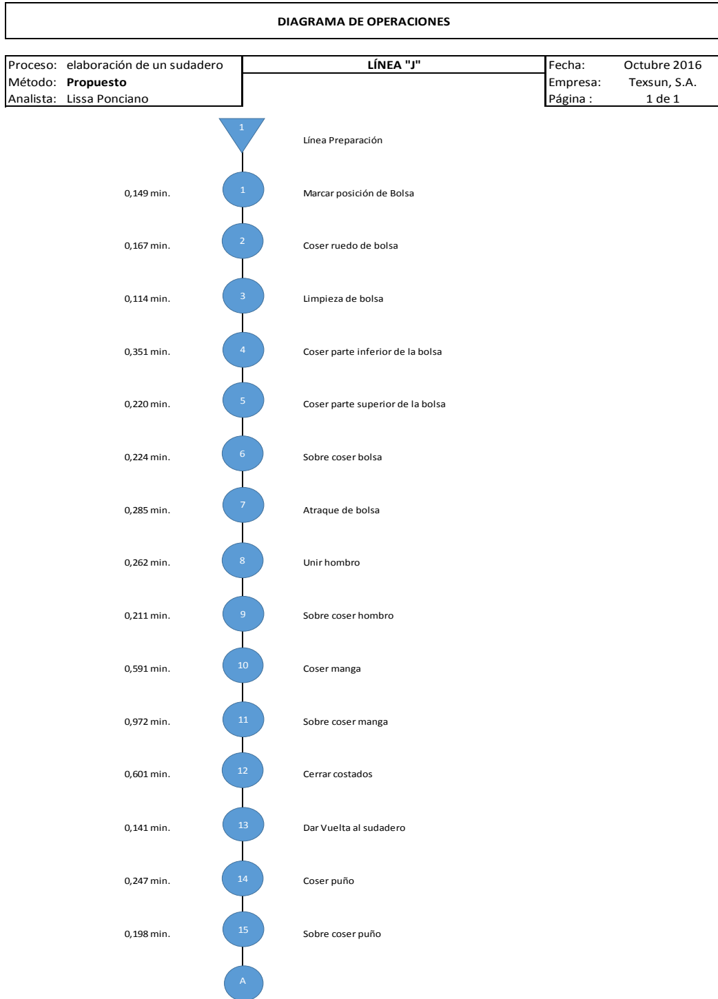
Figura 29. Diagrama de operaciones propuesto para la línea “J”
