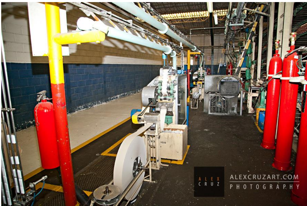
Figura 10. Máquina formadora de gavetas
