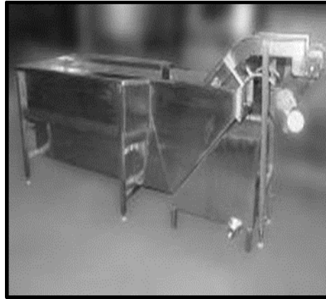
Figura 23. Máquina lavadora de arveja y ejote francés
