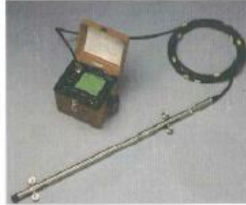
Figura 8. Sonda inclinométrica y caja de toma de datos
