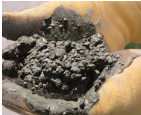
Figura 3. Mezcla con excesiva cantidad de agua
