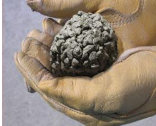
Figura 2. Mezcla con adecuada cantidad de agua
