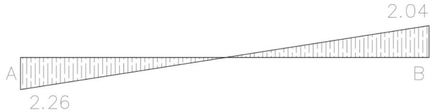
Figura 32. Esfuerzo cortante en viga
