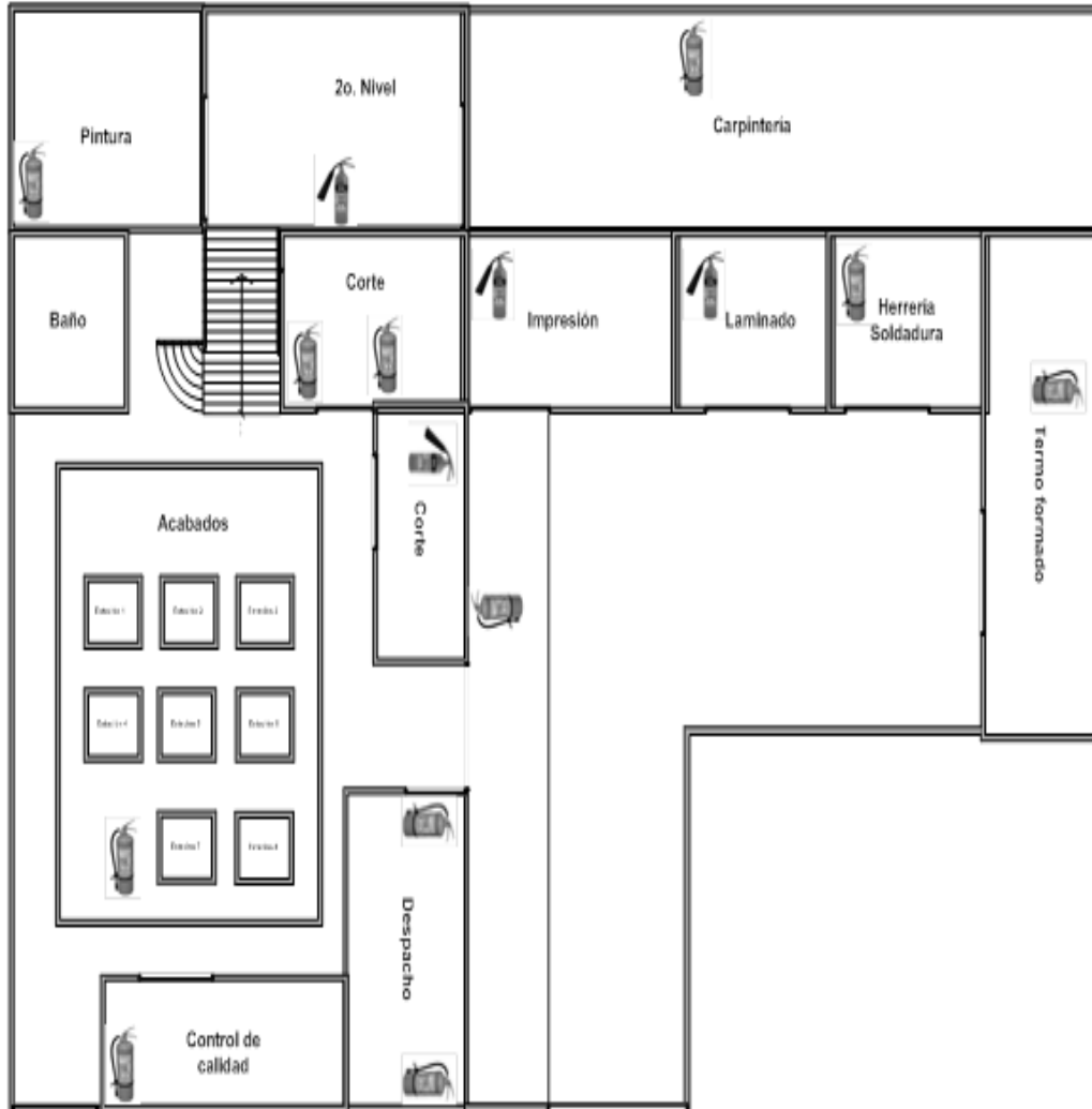
Figura 65. Plano de extintores del área de producción
