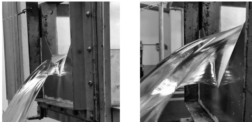
Figura 47. Vertedero triangular de 60° (VT-60°)
