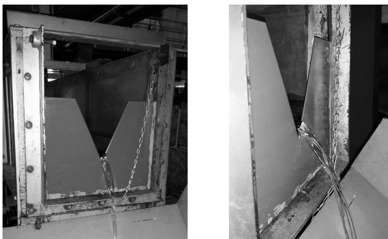
Figura 42. Vertedero triangular de 50° (VT-50°)
