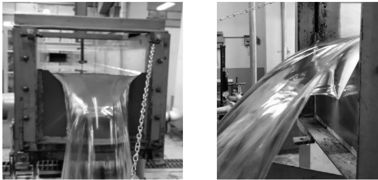
Figura 57. Vertedero triangular de 80° (VT-80°)
