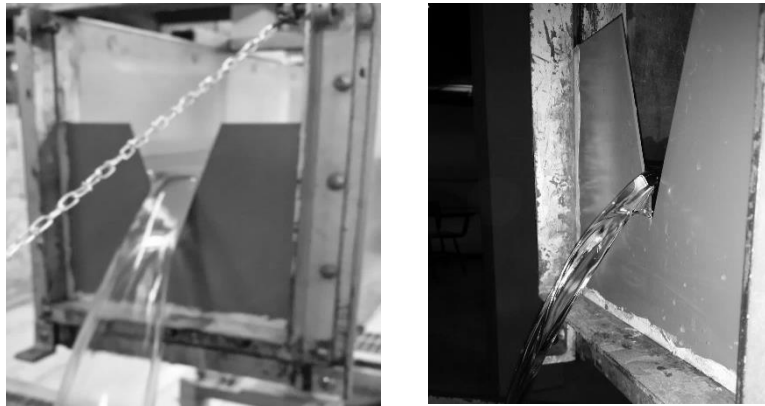
Figura 37. Vertedero triangular de 45° (VT-45°)
