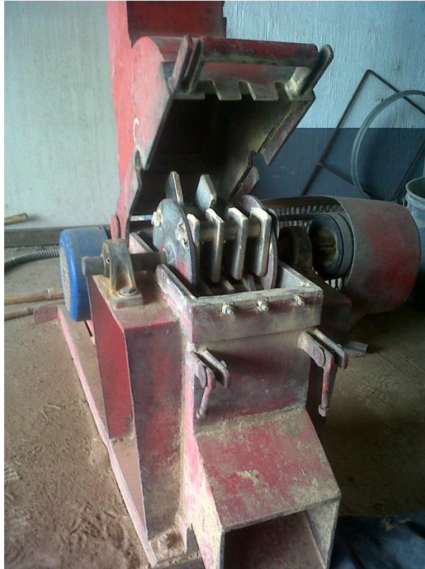
Figura 5. Cámara de trituración del molino de martillos
