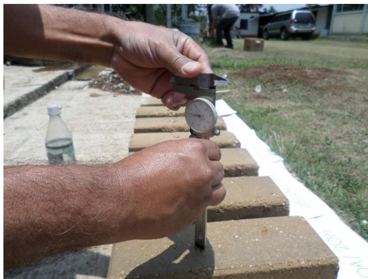
Figura 59. Medida de las oquedades, ensayo de erosión acelerada Swinburne (SAET)
