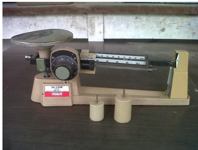
Figura 6. Balanza mecánica de precisión, marca Ohaus, 2 610 g de capacidad y 0,1 g de precisión
