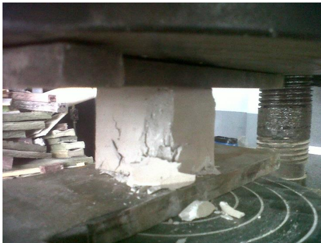
Figura 42. Falla a compresión luego del ensayo
