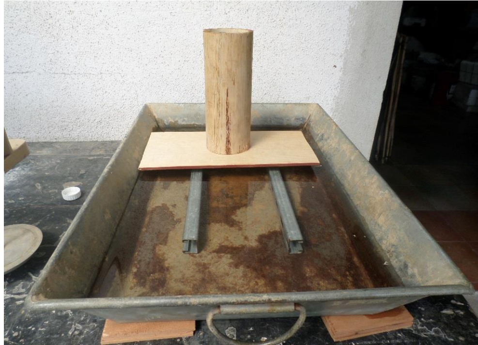
Figura 25. Equipo utilizado en el ensayo de absorción de agua por capilaridad
