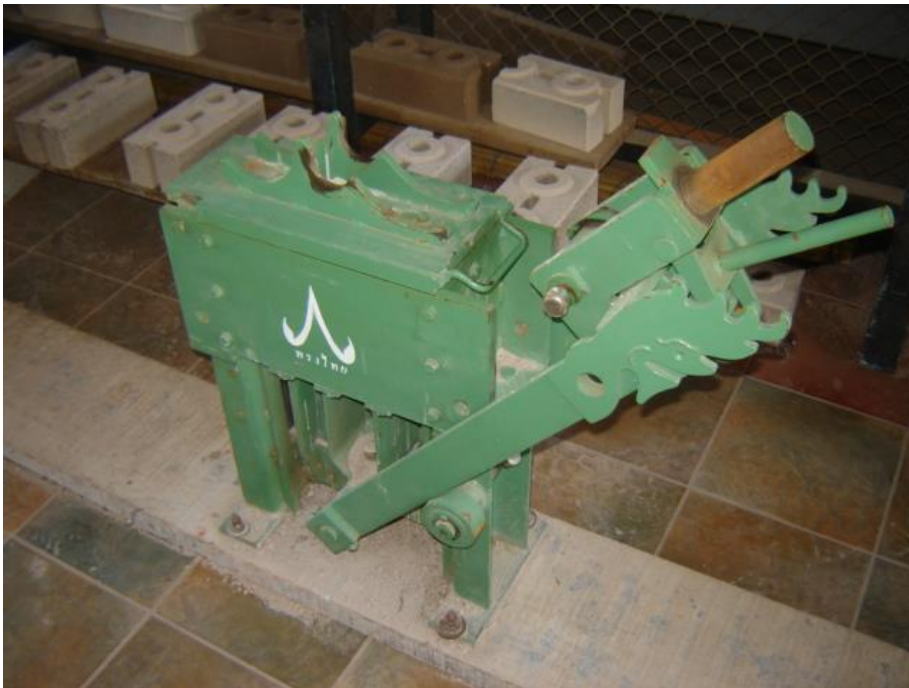
Figura 17. Prensa manual para la fabricación de BTC
