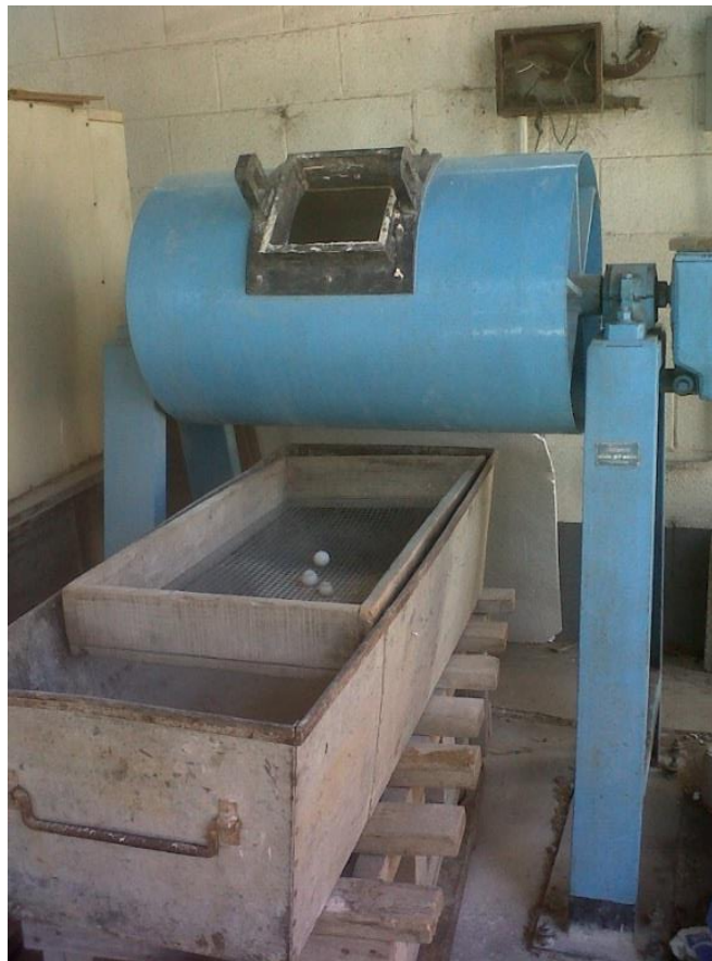
Figura 2. Molino de bolas, marca Patterson con 0,1 m 3 de capacidad
