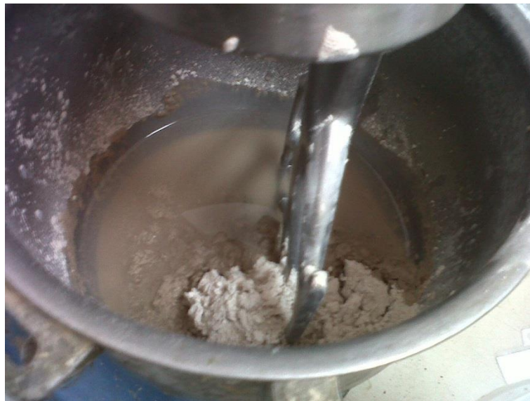
Figura 34. Mezclado del material en la mezcladora
