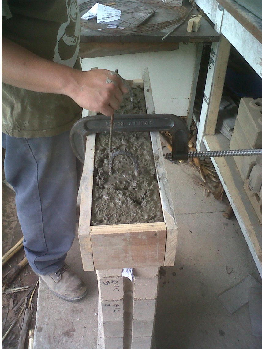
Figura 7. Armado y formateado de la solera de confinamiento del prisma
