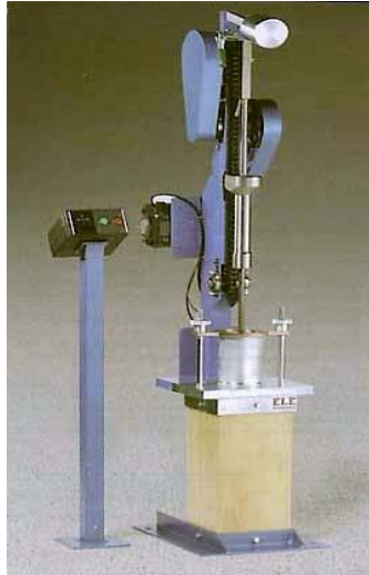
Figura 23. Molde y collar de extensión del molde compactación y pedestal de compactación
