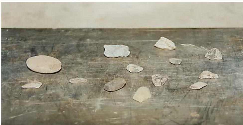
Figura 10. Partículas con una, dos o más caras fracturadas
