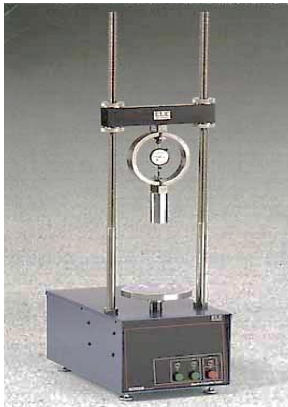
Figura 22. Máquina de estabilidad Marshall con anillo de carga
