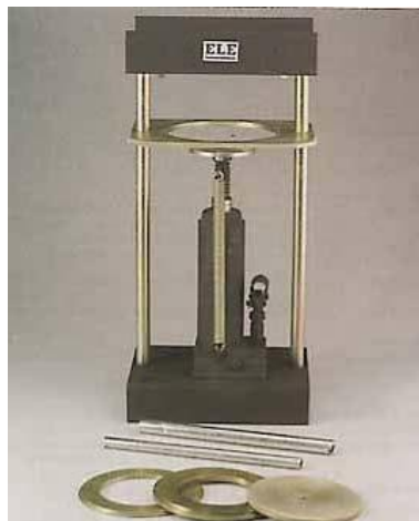
Figura 24. Para extraer la probeta compactada del molde se requiere el extractor de muestras de asfaltos
