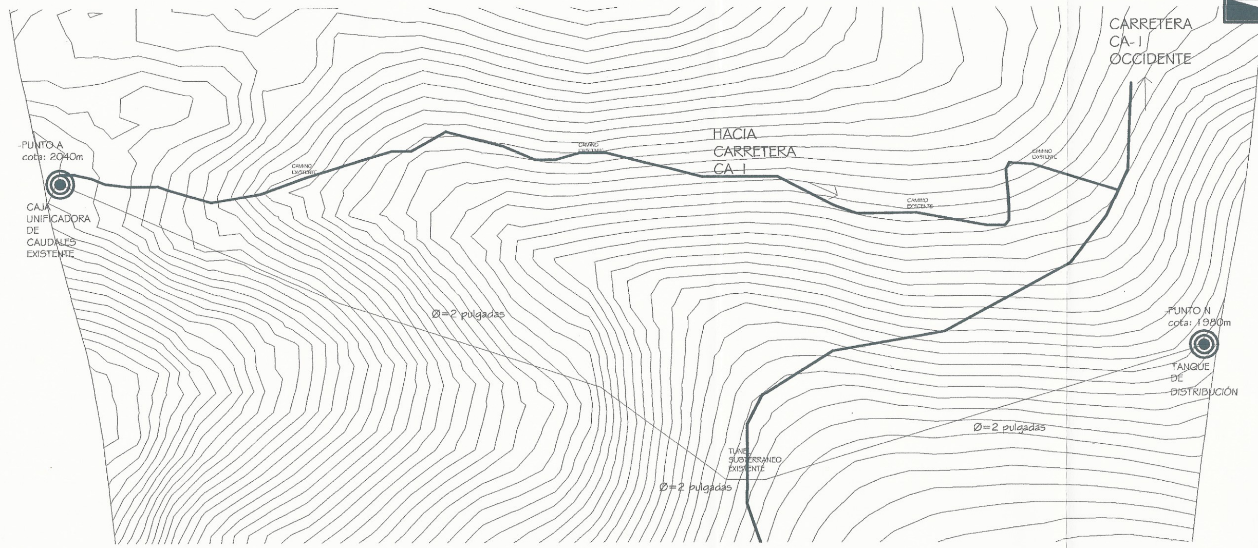
PIEZOMÉTRICA CAJA "A" HACIA TANQUE DE DISTRIBUCIÓN
