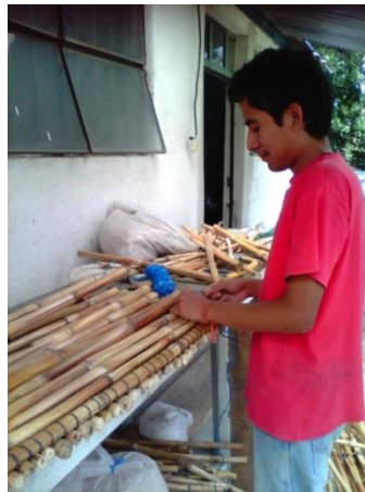
Figura 35. Elaboración preliminar de paneles de caña de maíz
