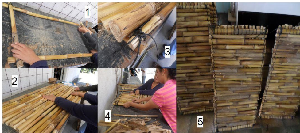
Figura 39. Pasos básicos para la fabricación de los paneles de 1 y 2 capas
