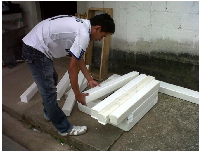
Figura 37. Armado de caja de poliestireno expandido
