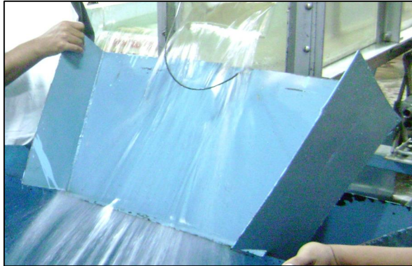
Figura 22. Compuerta para desviar flujo hacia el tanque
