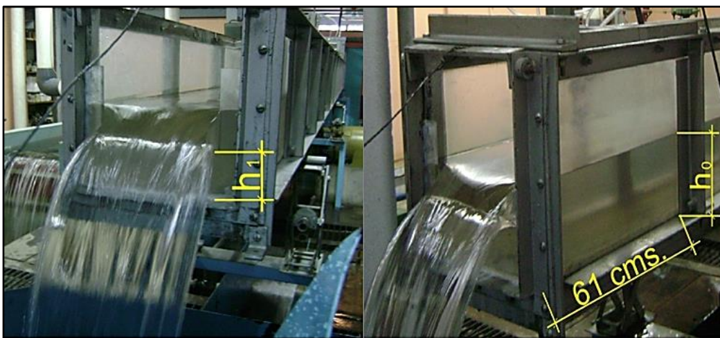
Figura 26. Vertedero rectangular en el laboratorio
