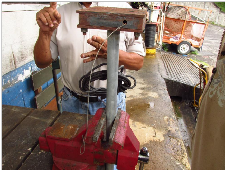
Figura 41. Extensómetro artesanal con alarma de disparo
