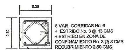
DETALLE DE COLUMNA C-1 CENTRO DE SALUD ESC. 1:10
