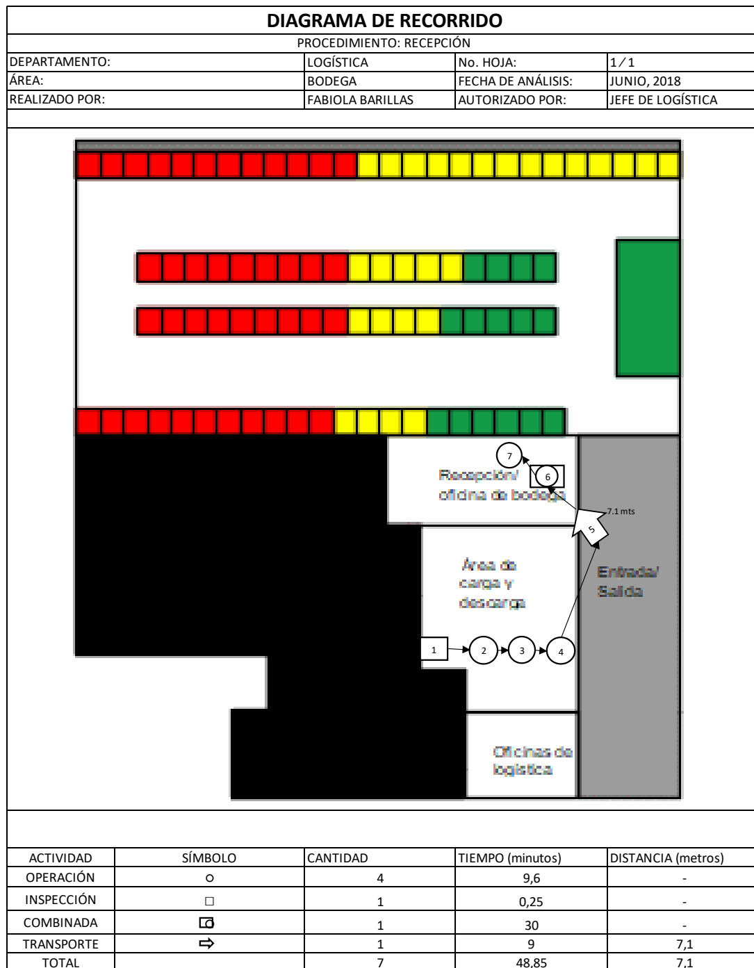
Figura 63. Diagrama de recorrido del procedimiento de recepción
