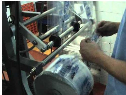
Figura 4. Colocación de bobinas en envasadora
