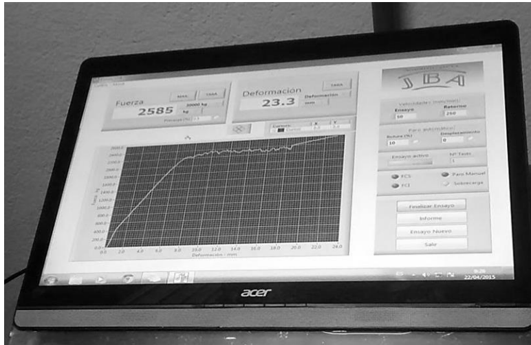
Figura 27. Desarrollo digital de la gráfica esfuerzo-deformación
