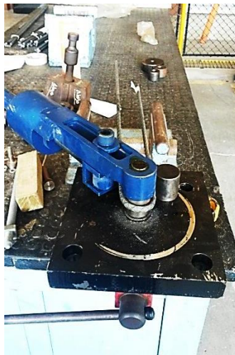
Figura 30. Doblado de la muestra a 180°
