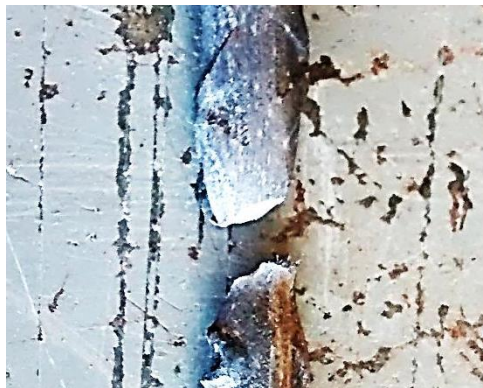
Figura 54. Falla irregular fibrosa
