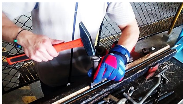
Figura 21. Marcado de muestras a cada 5 cm (2")
