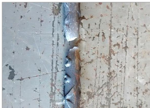
Figura 24. Piezas separadas después del ensayo
