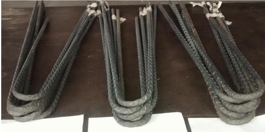
Figura 32. Verificación visual de las muestras para detectar fisuras
