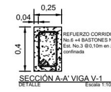
**SECCIÓN A-A' VIGA V-1**
