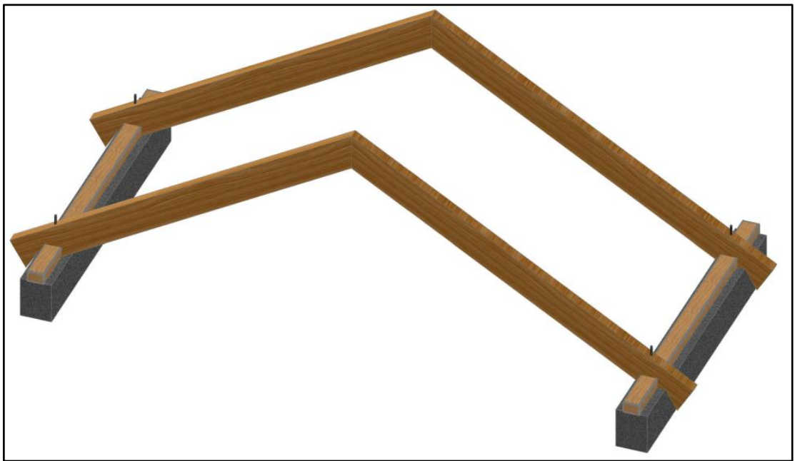
Figura 92. Colocación de tijeras de madera sobre solera
