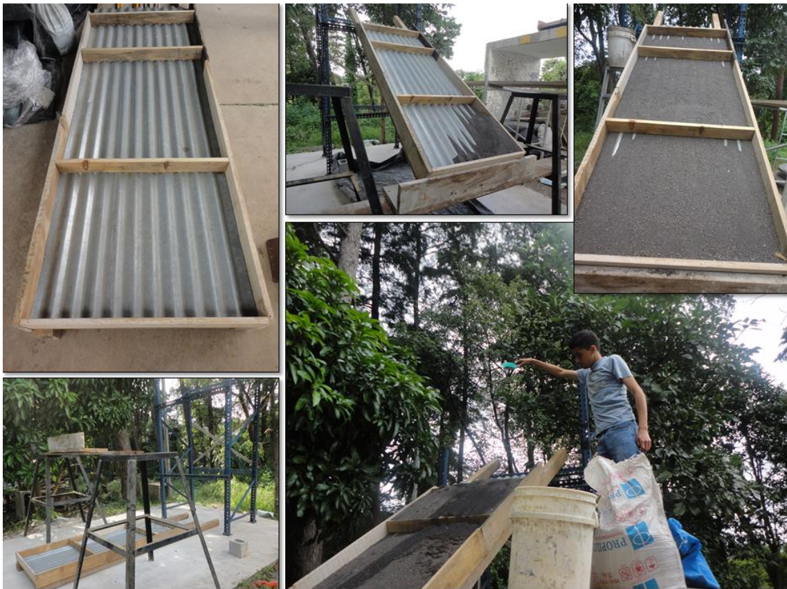
Figura 43. Ensayo de arena sobre la cubierta
