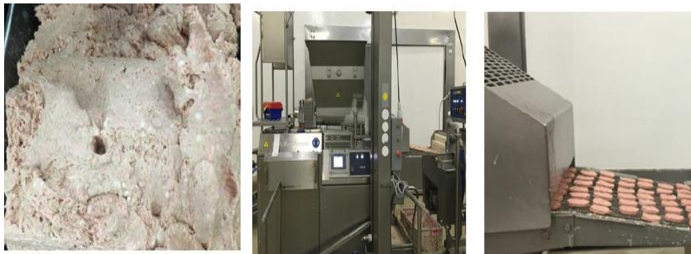
Figura 7. Alimentación de pasta cárnica en la maquina
