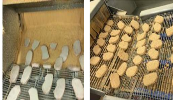
Figura 9. Aplicación de empanizado
