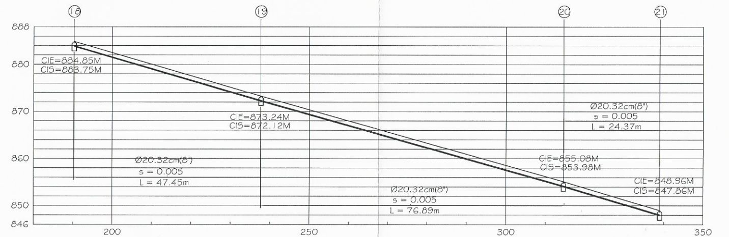
PERFIL POZO 18 - POZO 21 ESCALA HORIZONTAL 1:1,000 ESCALA VERTICAL 1:500
