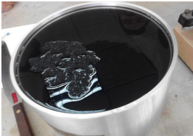
Figura 11. Contenedor con mezcla asfáltica llena de agua
