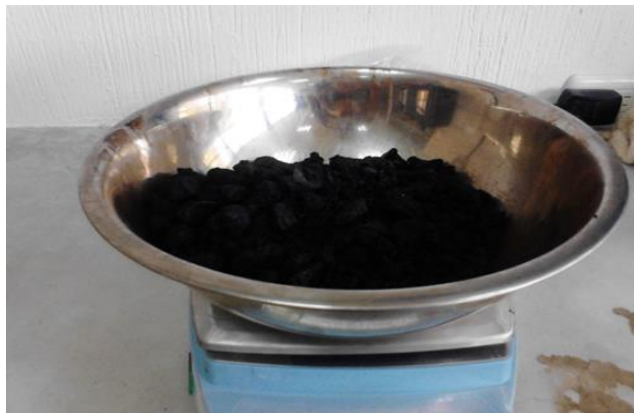
Figura 13. Mezcla asfáltica deshecha y pesada
