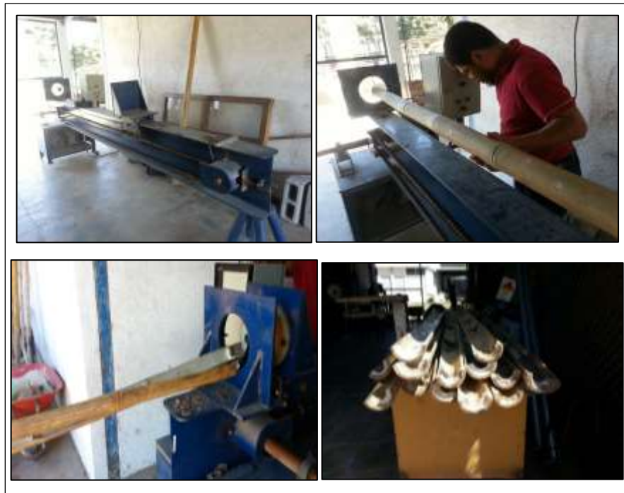
Figura 27. Corte longitudinal del bambú
