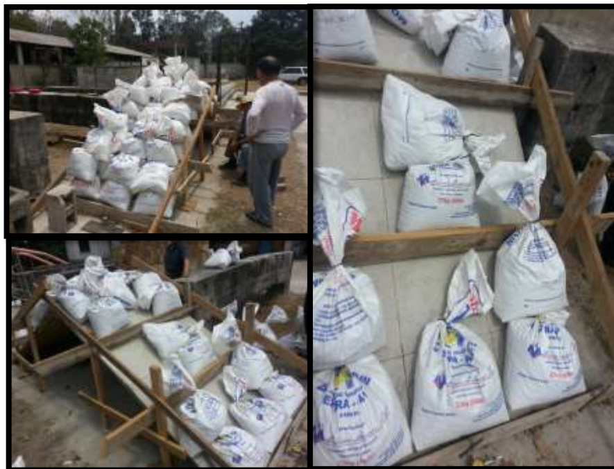
Figura 38. Ensayo de la cubierta bambú ferrocemento aplicando la carga de diseño
