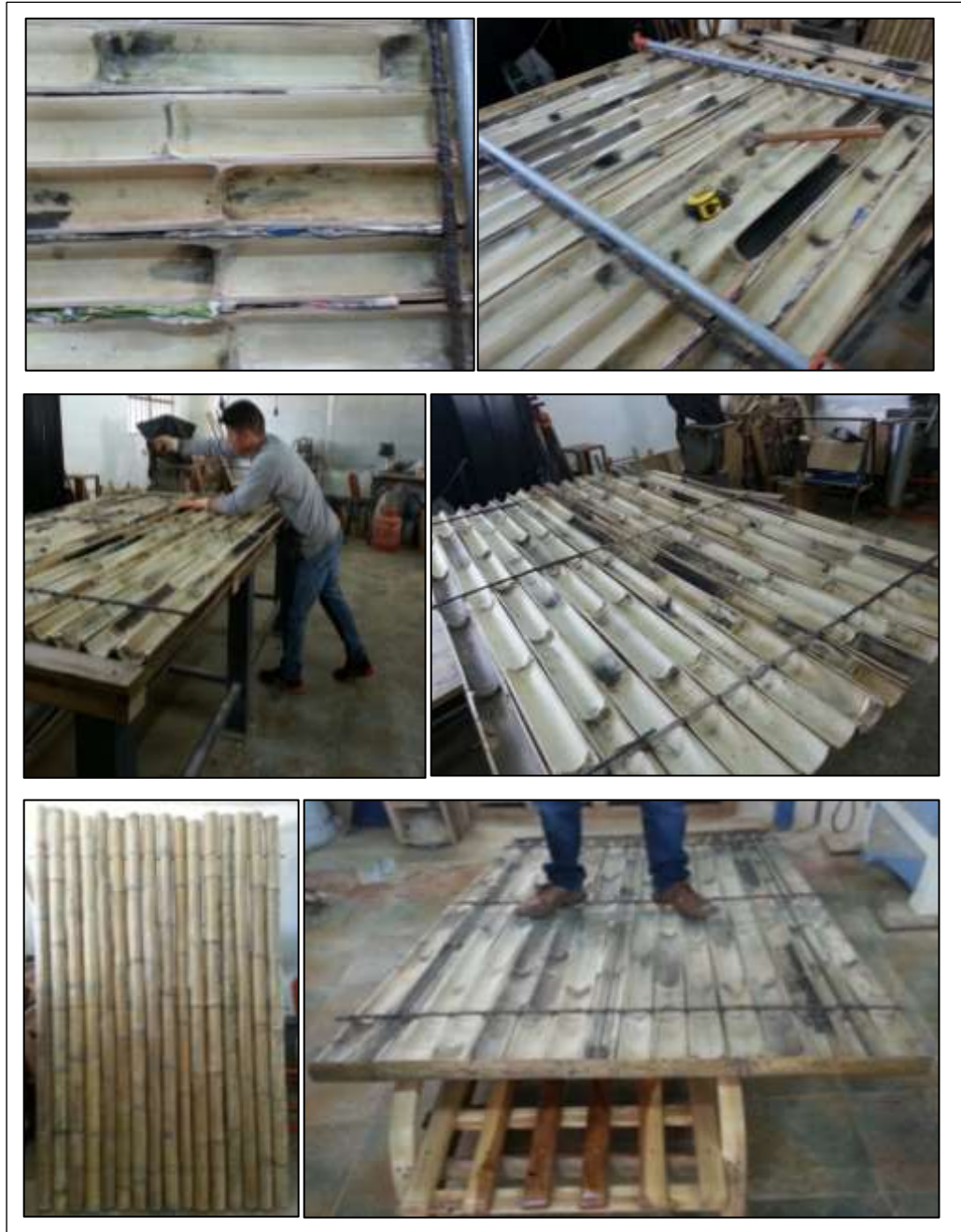
Figura 29. Colocación del refuerzo longitudinal y transversal
