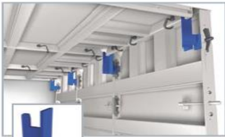
Soporte para cuchilla, el cual se fija a la formaleta de muro con pasador y cuña.
