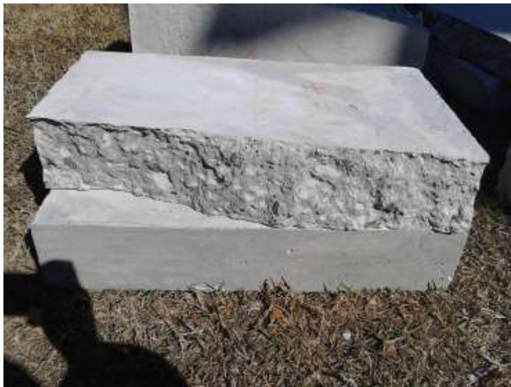
Figura 66. Efecto dovela en los agregados de la losa de 12 cm de espesor de concreto simple
