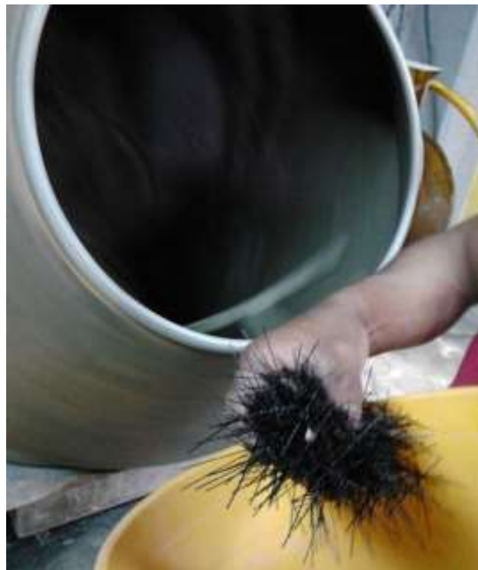
Figura 20. Adición de la fibra de polipropileno durante el mezclado
