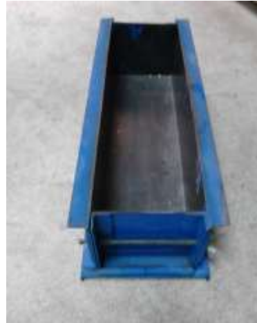
Figura 29. Molde de metal para hacer las vigas
