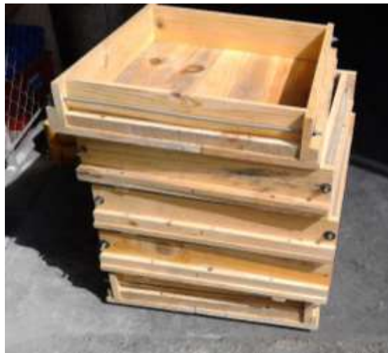
Figura 28. Moldes de madera para fundición de losas
