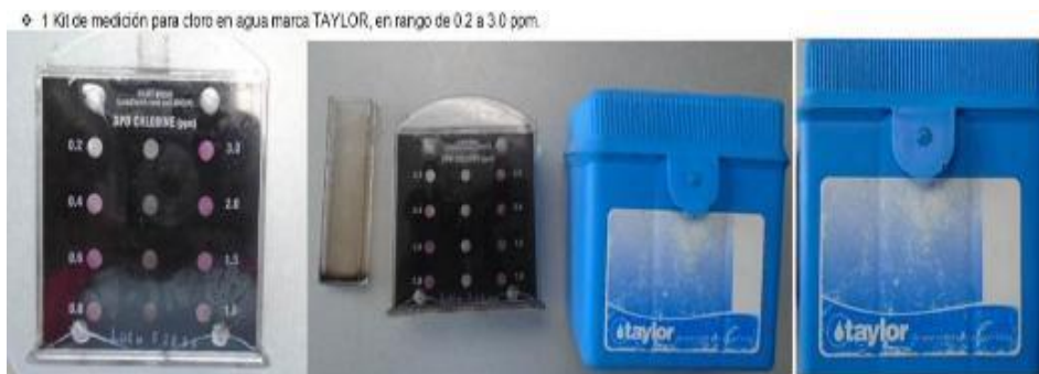
Figura 43. Test de medición de TAYLOR
