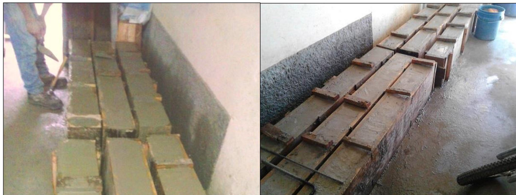
Figura 37. Curado de vigas
