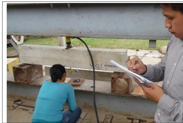
Figura 38. Instalación de viga para ensayo
