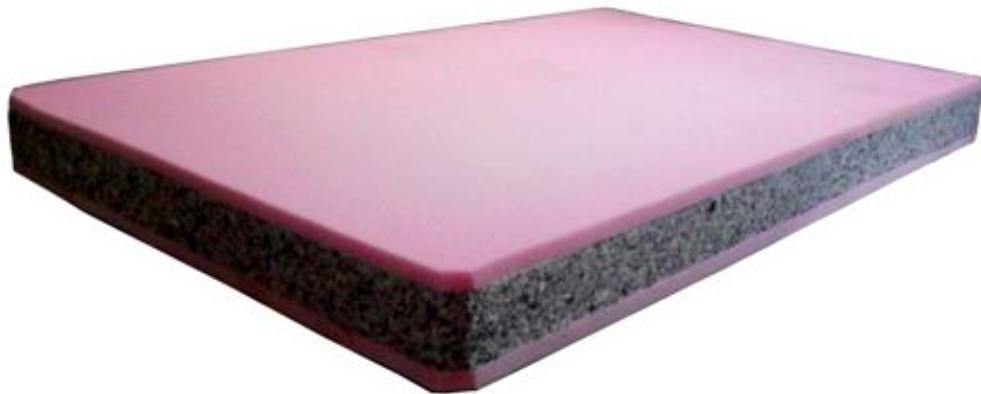
Figura 23. Cápsula combinada (esponja y aglutinado)
