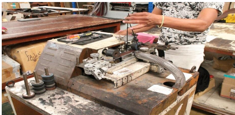
Figura 22. Desvirado de cantos
