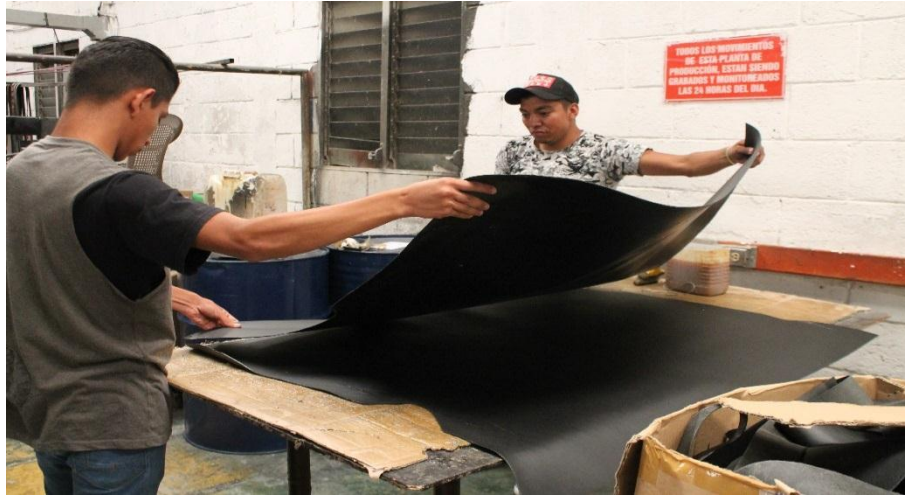
Figura 19. Pegado de paneles
