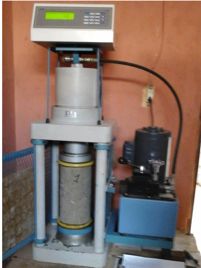
Figura 32. Control de resistencia de concreto en laboratorio
