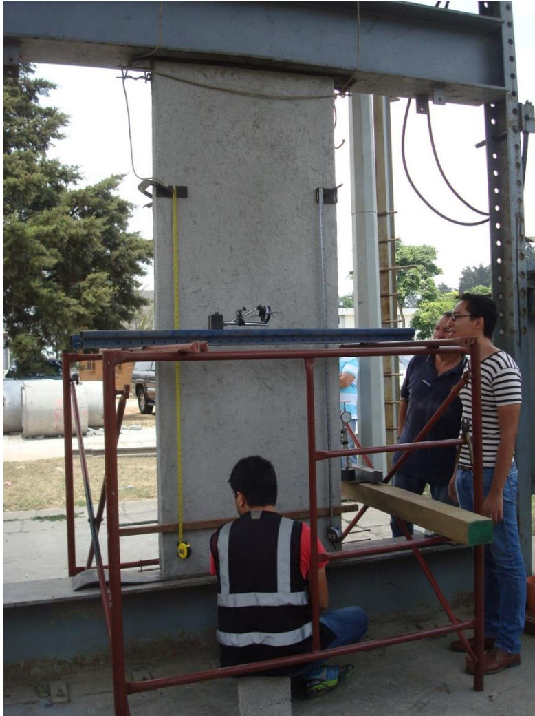
Figura 22. Ensayo por compresión
