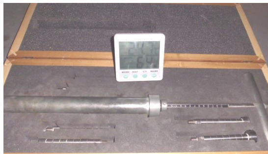
Figura 20. Aparato para ensayo de velocidad de fraguado
