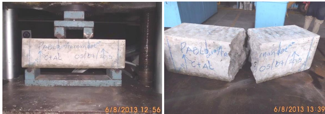
Figura 39. Ensayo de flexión en viga caliza + arena caliza
