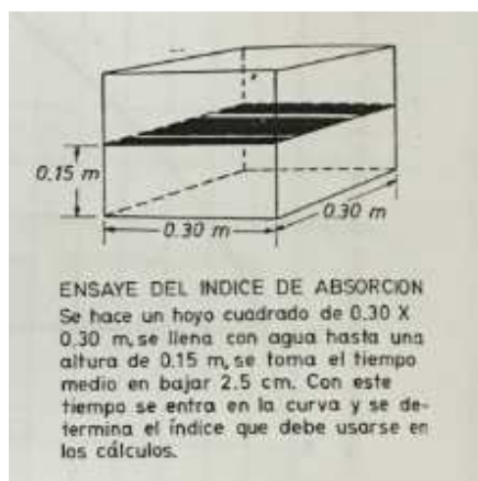
Figura 18. Ensayo índice de absorción
