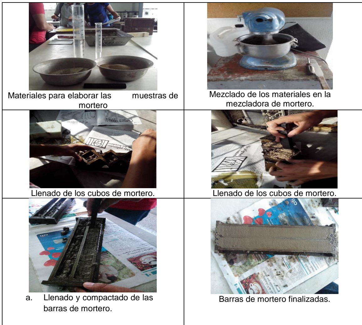
Figura 16. Elaboración de cubos, briquetas y barras de mortero
