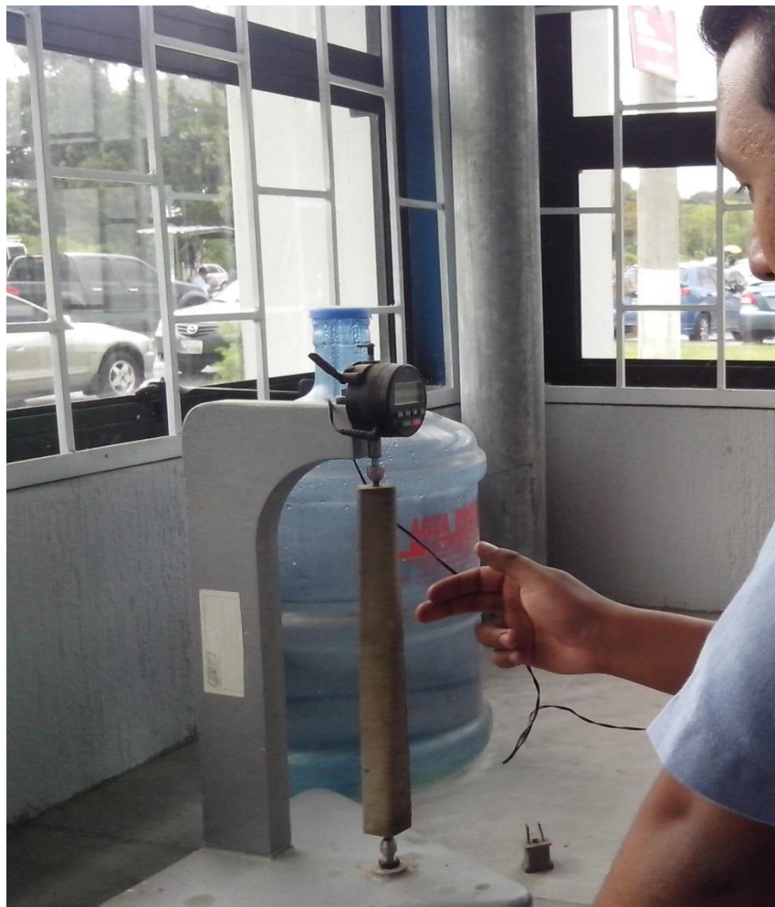
Figura 19. Medición de expansión o contracción de barra de mortero
