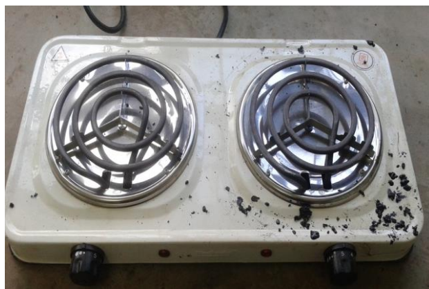
Figura 6. Equipo utilizado para calentar mezcla asfáltica
