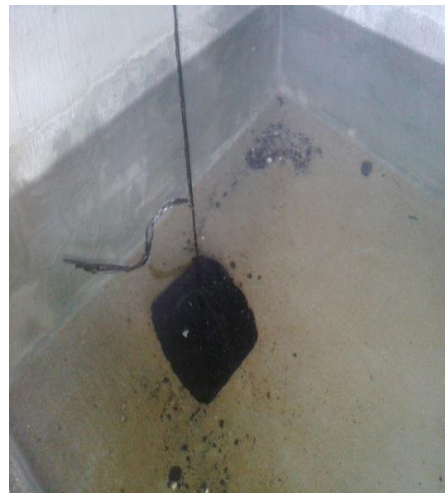
(b) Pileta de agua para suspensión de probeta.
