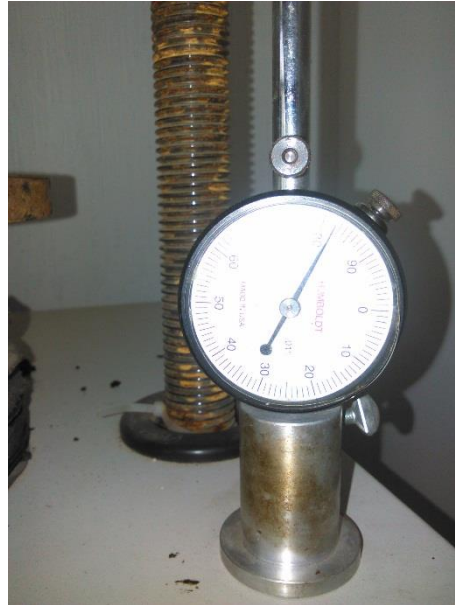
Figura 19. Medidor de deformación
