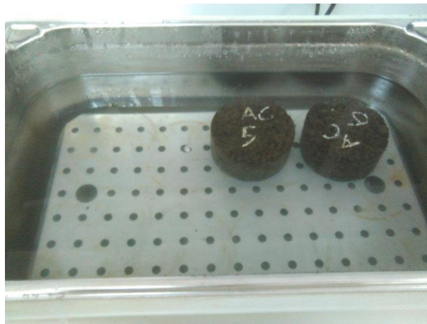
Figura 23. Tanque para agua controlado
