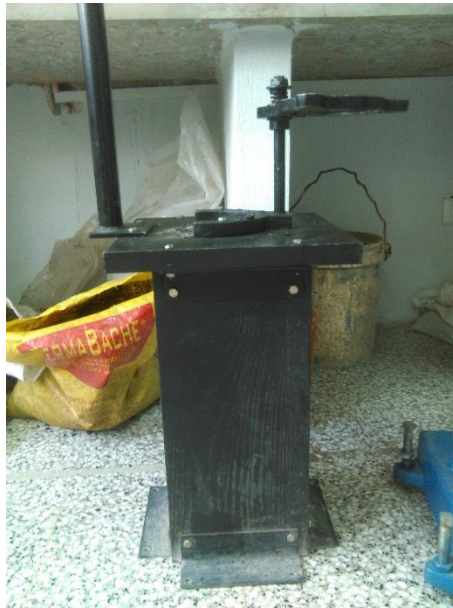
Figura 15. Pedestal de compactación
