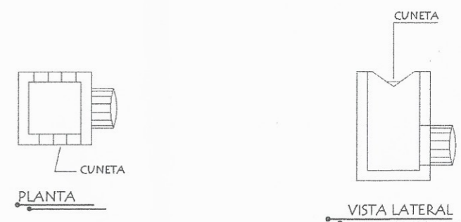
DETALLES DE CAJA RECOLECTORA
