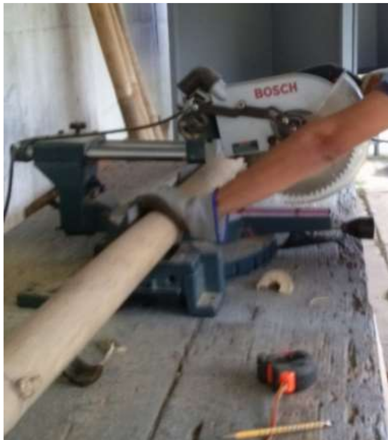
Figura 40. Corte con sierra ingletadora
