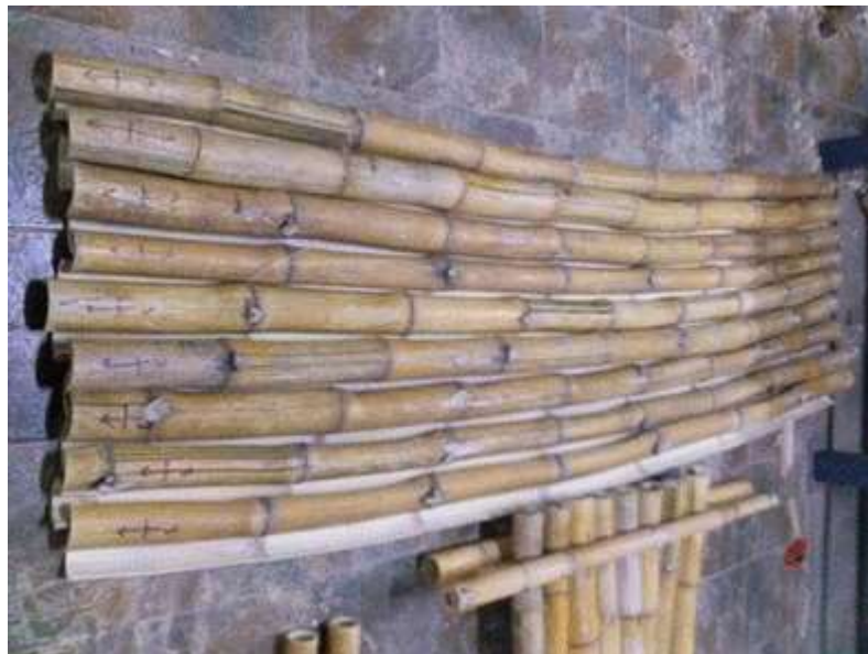
Figura 34. Acomodamiento de cañas de bambú según su curvatura
