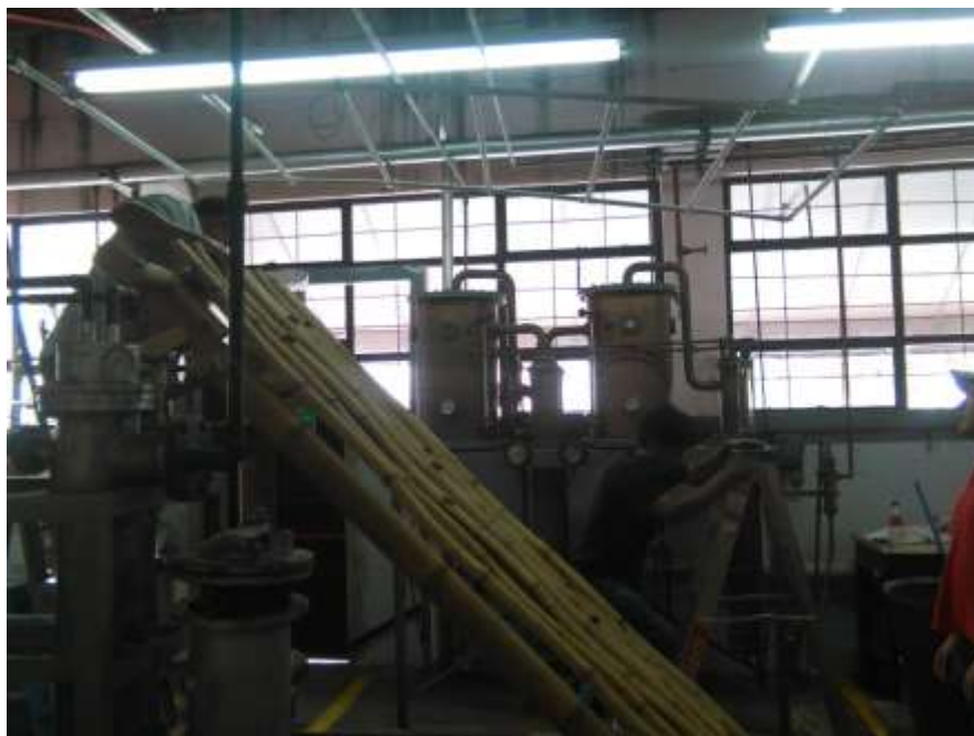
Figura 18. Armado de sistema para ensayo de absorción
