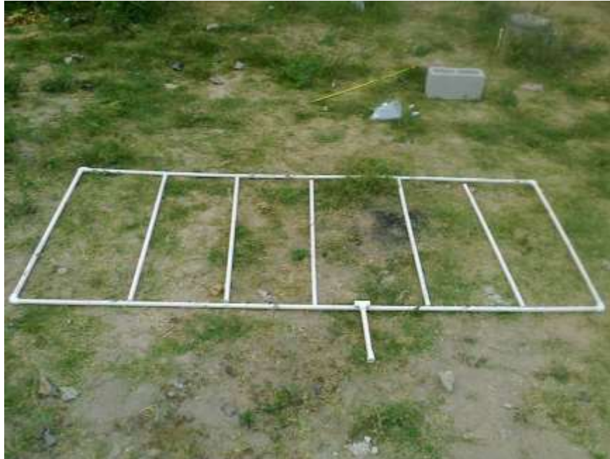
Figura 20. Simulador de lluvia
