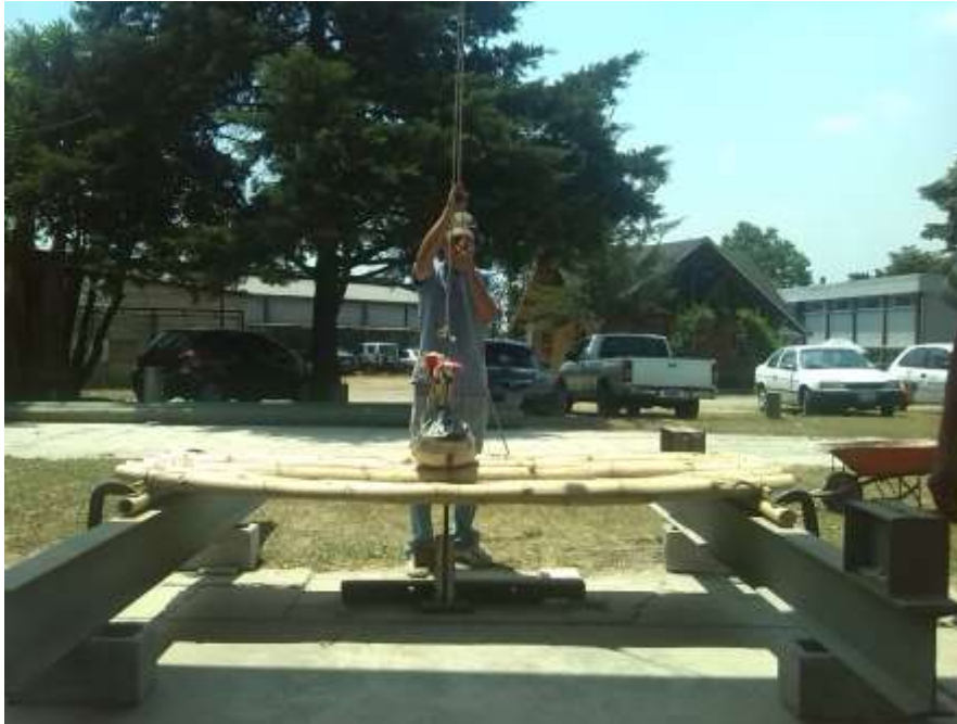
Figura 16. Armado de sistema para ensayo de impacto
