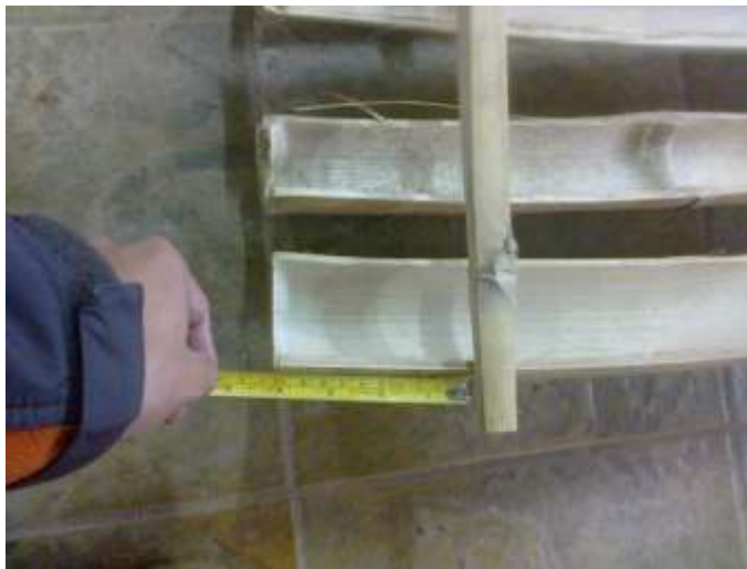
Figura 46. Medición para ubicar el pasador
