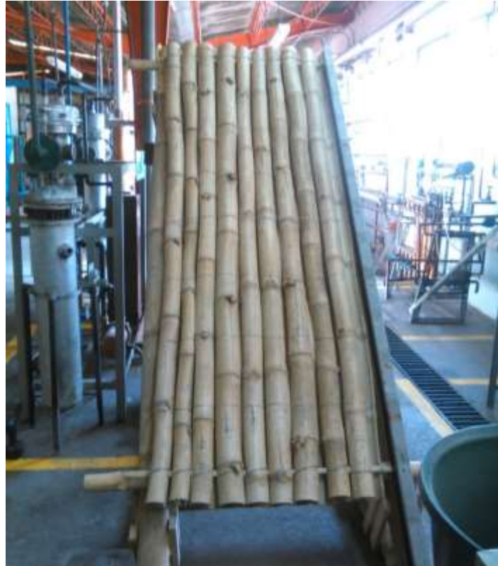
Figura 64. Cubierta de techo elaborada con bambú
