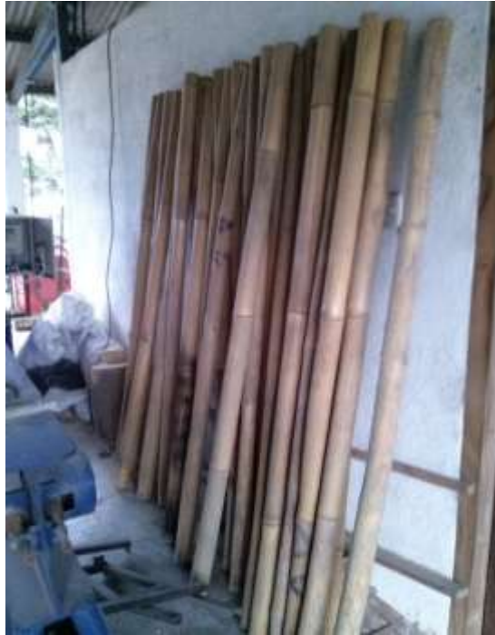
Figura 41. Bambú cortado con la misma longitud
