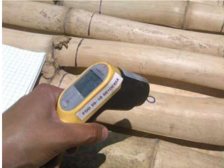
Figura 21. Toma de temperatura con termómetro laser
