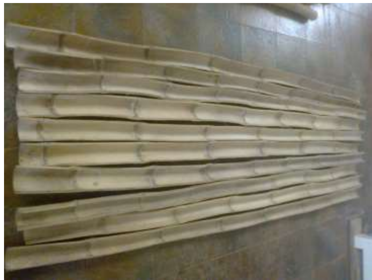
Figura 43. Bambú cortado por la mitad y sin nudos
