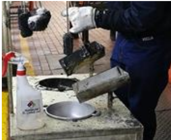
Figura 53. Eliminación de exceso de lubricante
