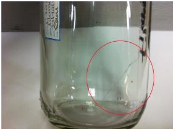
Figura 17. Defecto crítico filamento
