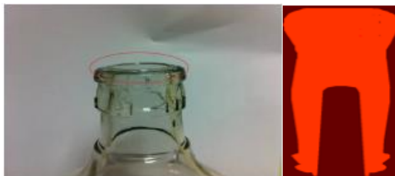
Figura 16. Defecto crítico gorro
