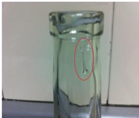
Figura 19. Defecto crítico rebaba
