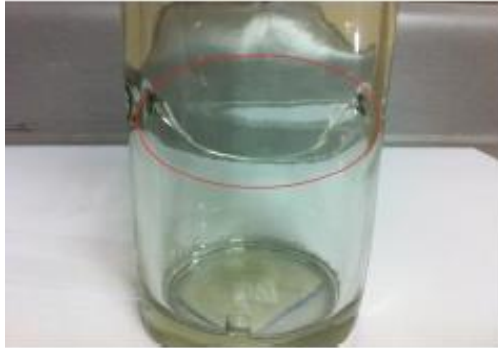
Figura 18. Defecto crítico columpio
