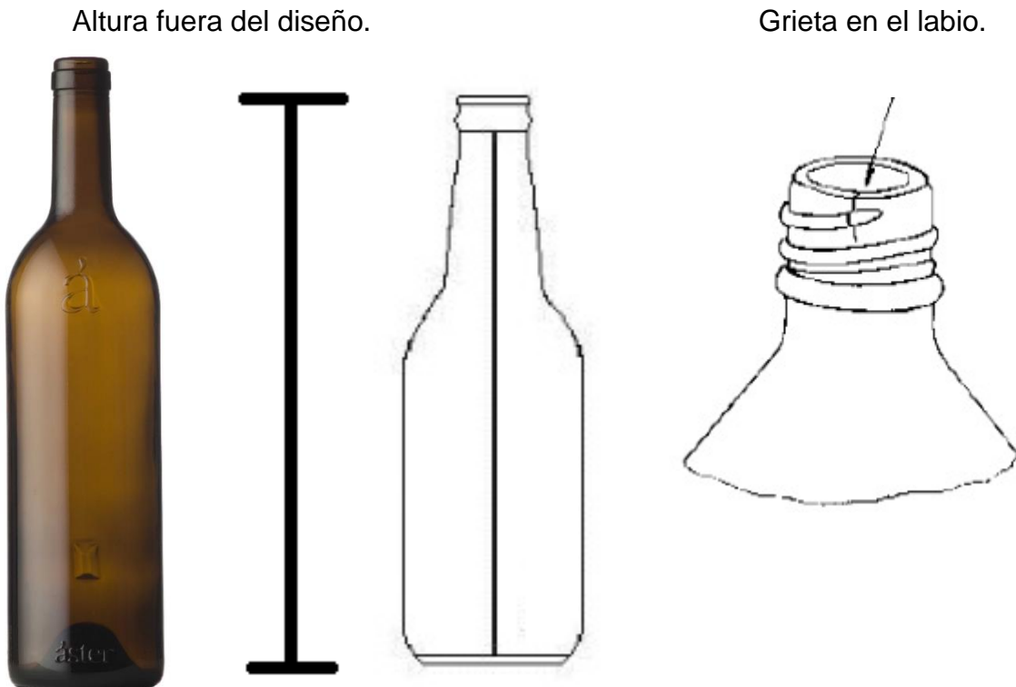
Figura 15. Defecto mayor: altura fuera del diseño
