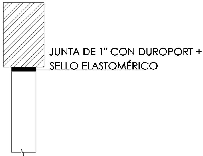
Figura 55. Detalle de junta entre viga y muro de mampostería
