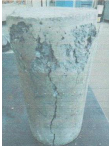
Figura 18. Falla columnar en cilindro con 50% de vidrio
