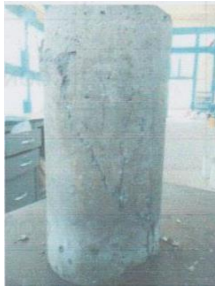
Figura 20. Falla de corte en cilindro con 25% de vidrio
