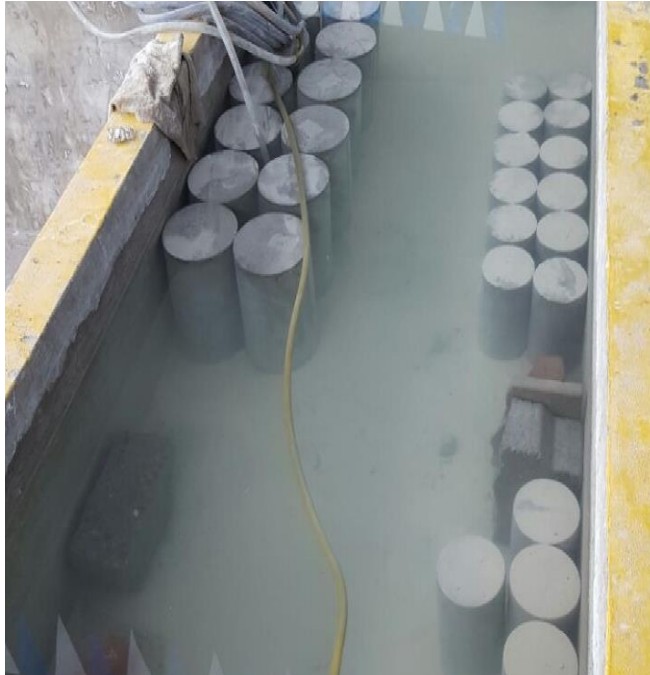
Figura 10. Curado de las probetas
