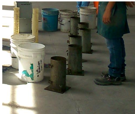
Figura 8. Moldes para la elaboración de los cilindros
