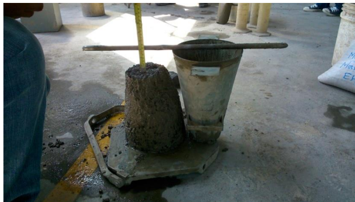
Figura 11. Medición del asentamiento
