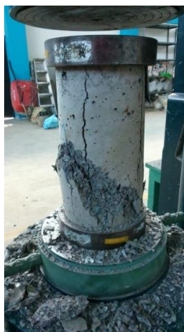
Figura 15. Falla cono y clivaje en cilindro
