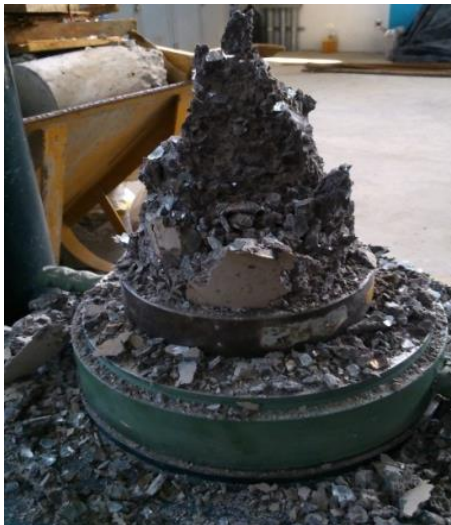
Figura 19. Falla de cono y clivaje
