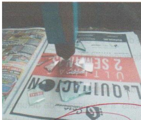
Figura 5. Falla por fatiga en probeta
