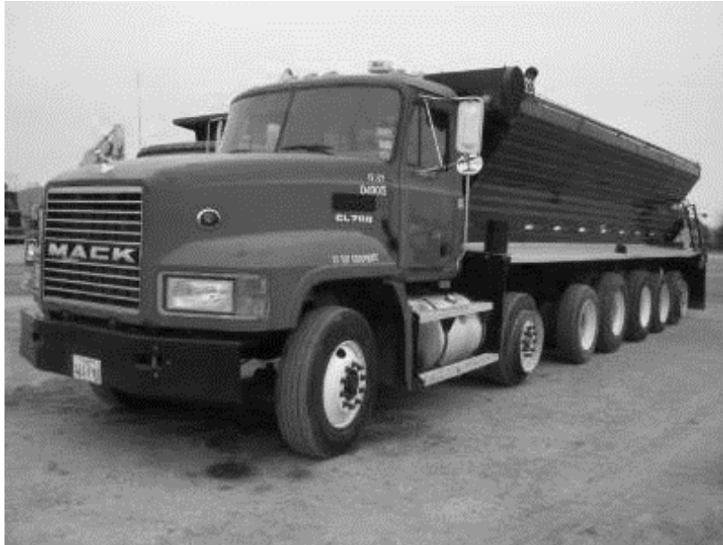
Figura 41. Vehículo de transporte de mezcla, descarga inferior
