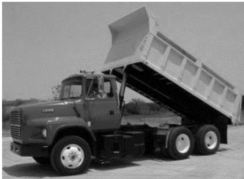
Figura 40. Vehículo de transporte de mezcla, descarga superior
