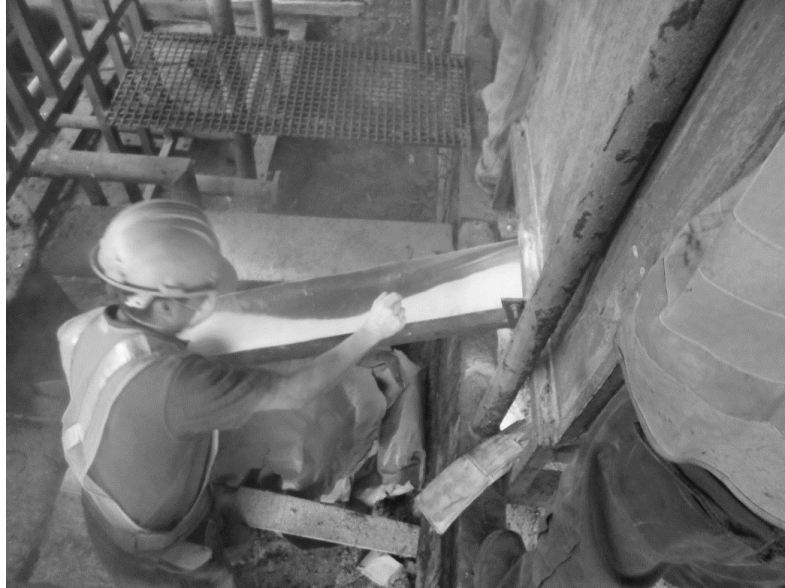
Figura 28. Dosificación del co polímero SBS al tanque de molienda
