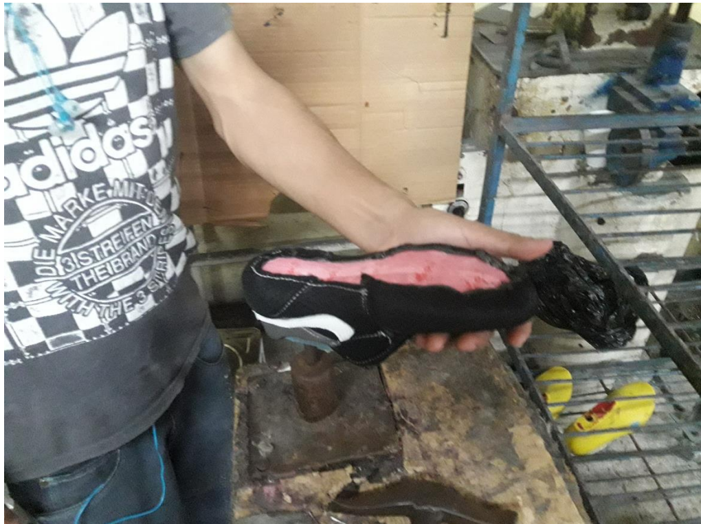
Figura 16. Colocación de horma
