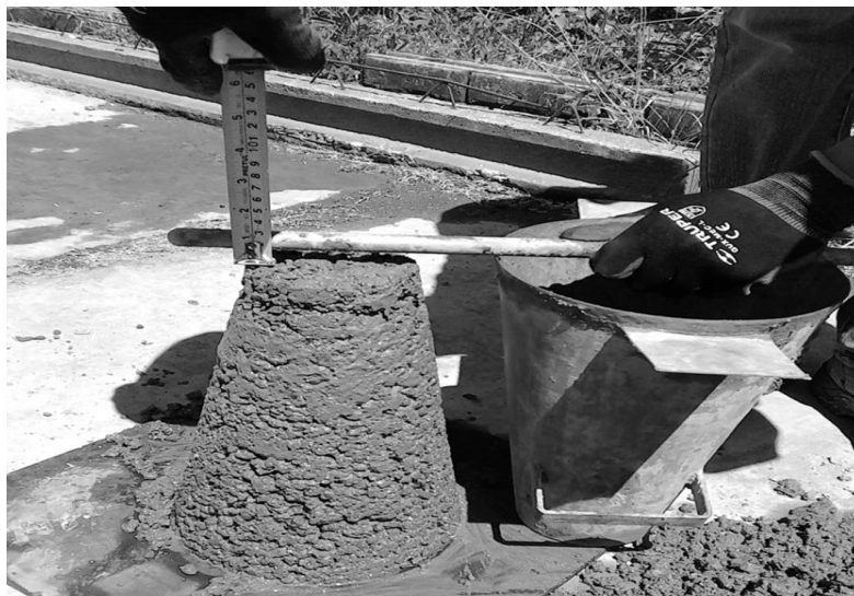
Figura 6. Muestra de ensayo de revenimiento
