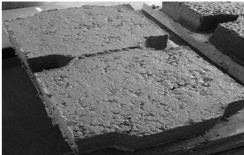
Figura 5. Muestra de adoquines con mezcla patrón
