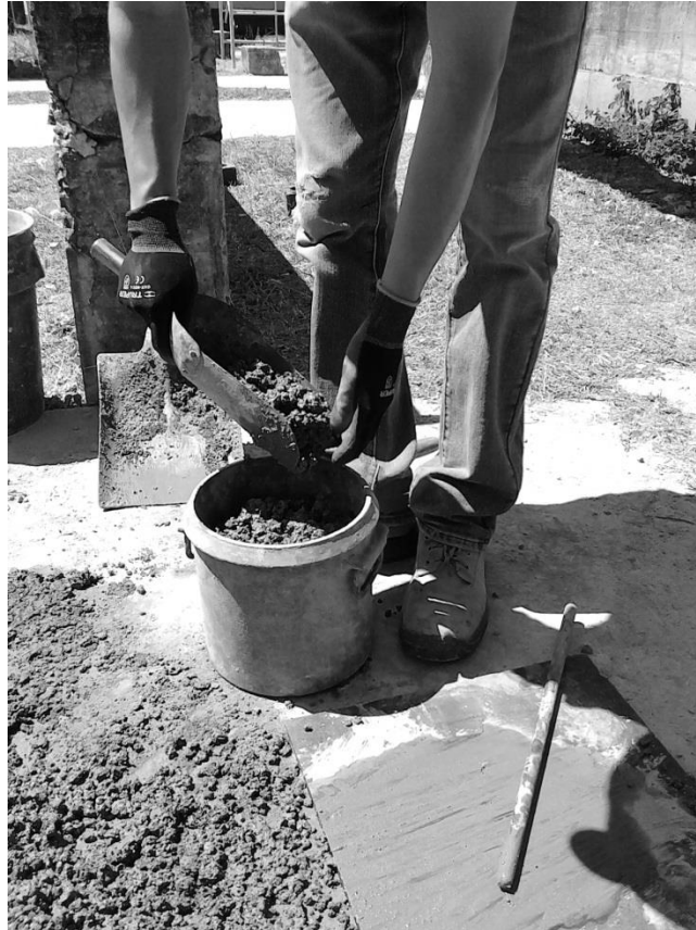
Figura 7. Muestra del procedimiento de ensayo de peso unitario del concreto
