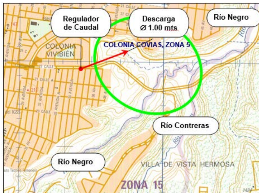
Figura 30. Ubicación del regulador de caudal
